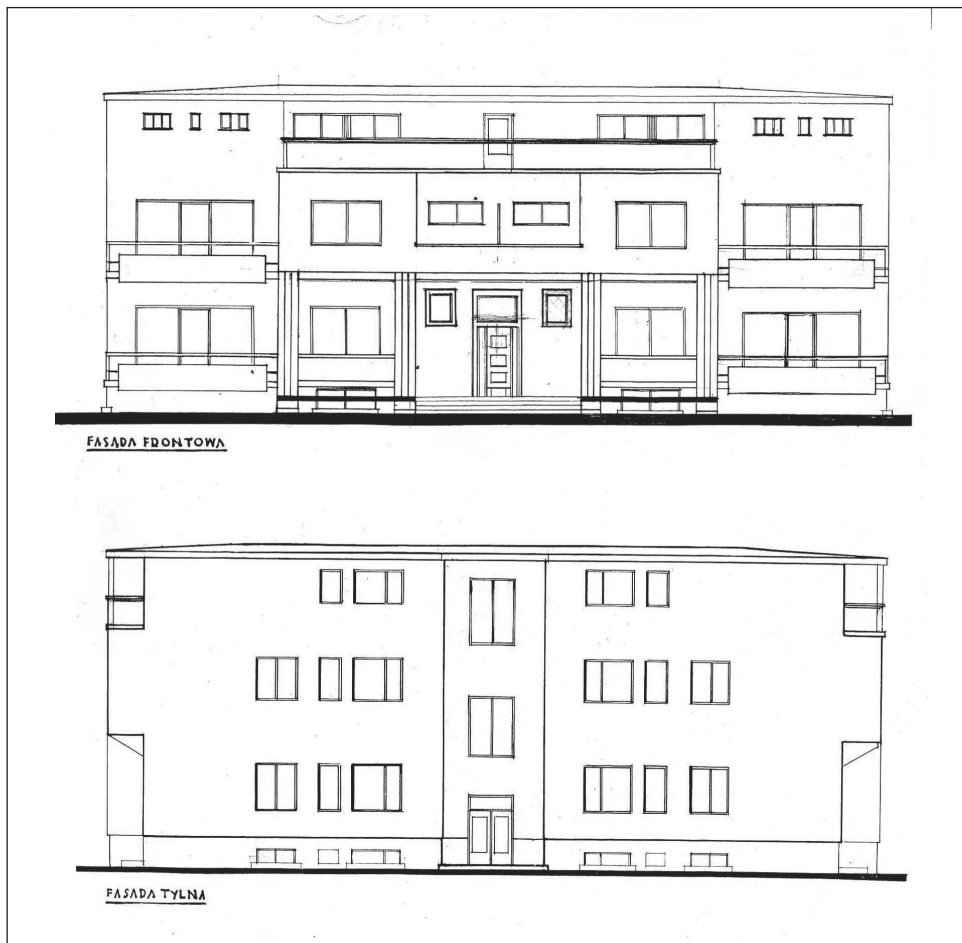
20. R. Szwarc, Projekt budynku mieszkalnego braci S. i S. Ginzburg przy ul. Cieszyńskiej i Złotej (Cieszyńskiej 3a) – elewacja frontowa i tylna, 1936. Oryginał APW Oddział w Otwocku, AmO, sygn. 2393, k.9,10
