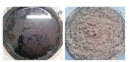
Fig. 4. Foam images using air bubbles (on the left) and oily bubbles (on the right) Rys. 4. Zdjęcia pęcherzyka powietrznego (lewa strona) i pęcherzyka oleistego (prawa strona)
