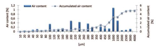
Fig. 2. The porosity characteristics of non air-entrained SCC (CEM II 32.5 R B-S; *w/b*=0.29) [14]. Rys. 2. Charakterystyka porowatości nienapowietrzonego SCC (CEM II 32.5 R B-S; *w/s*=0.29) [14]
