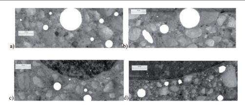
Fig. 4. Air voids in (a) B1, (b) C2, (c) B2, (d) C4. Rys. 4. Pory powietrzne w (a) B1, (b) C2, (c) B2, (d) C4
