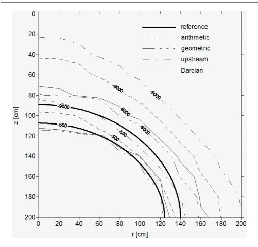
Fig. 4. Example 2: Pressure head isolines after 20 days for different conductivity averaging schemes. Rys. 4. Przykład 2: Izolinie wysokości ciśnienia po 20 dniach dla różnych sposobów uśredniania przewodności
