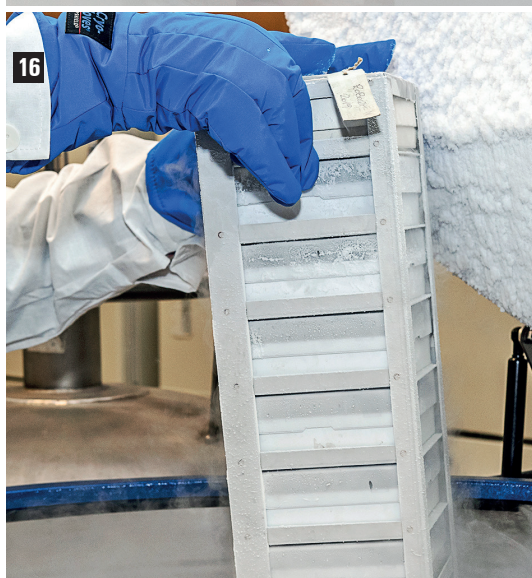
Fot. 16 Kriogeniczne przechowywanie nasion w banku nasion. Próbki nasion, umieszczone w kriogenicznych pojemnikach, zdeponowane w kasetach przechowywanych w ciekłym azocie (–196 st. C). Tego typu metoda długoterminowego zabezpieczenia nasion pozwala na zachowanie wysokiej żywotności i integralności materiału genetycznego przez dziesięciolecia, minimalizując tempo procesów starzenia
