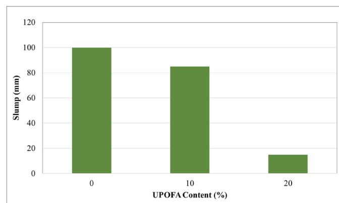
Fig. 1. Slump test result
