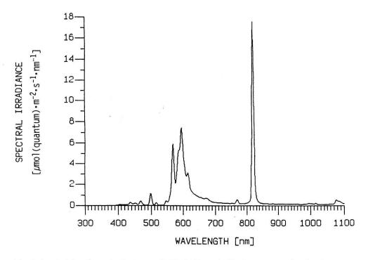
Fig. 3. Spectral irradiance in the range of 300-1100 nm inside the exposure chamber (measurement at 2 nm intervals with LI-1800 LI-COR USA) provided by Philips SOD-4 Agro 400W lamps Spektralne natężenie napromieniowania w zakresie 300-1100 nm wewnątrz komory ekspozycyjnej (lampy SOD-4 Agro 400W firmy Philips; pomiar w interwałach co 2 nm za pomocą spektroradiometru LI-1800 LI-COR USA)
