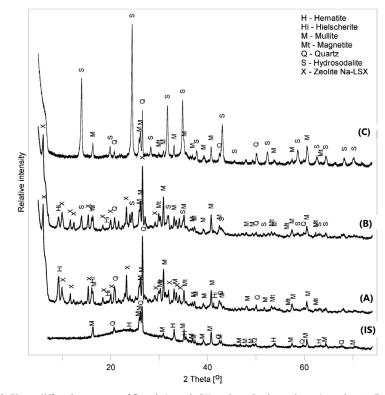
Fig. 2. X-ray diffraction pattern of fly ash (sample IS) and synthesis products (samples: A, B and C)Rys. 2. Dyfraktometr rentgenowski popiołu lotnego (próbka IS) i produktów syntezy (próbki: A, B i C)
