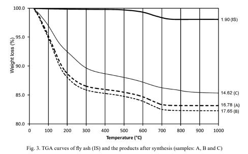
Rys. 3. Krzywe TGA popiołu lotnego (IS) oraz produktów po syntezie (próbki: A, B i C)
