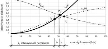
Rys. 1. Zmiany intensywności uszkodzeń w budynku nieremontowanym
