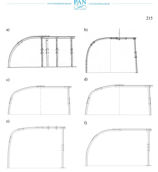
Fig. 1. Examples of structural solutions of the arch-rectangular support a – OŁPP (Komisja ds. Obudów Zmechanizowanych i Kierowania Stropem, 1997); b – ŁPSpN (Europejskie Technologie Górnicze, 2016); c – ŁPrOJ option 1; d – ŁPrOJ option 2; e – ŁPrO/A (Huta Łabędy, 2017); f – ŁPrO/B (Huta Łabędy, 2017)
