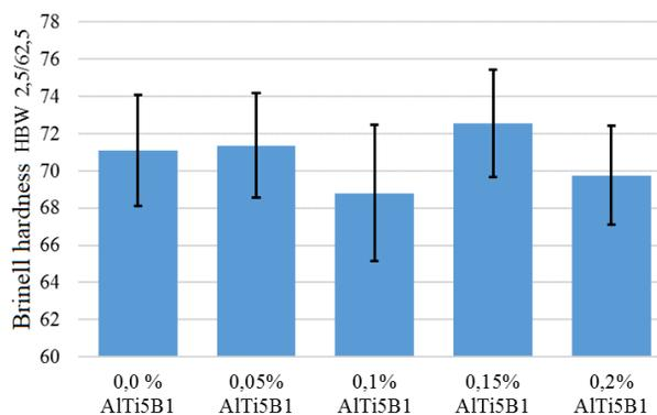
Fig. 29. Brinell hardness HBW
