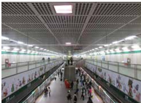
Fot. 11a. i 11b. Port lotniczy Roissy Charles de Gaulle (Francja) i Taipei (Rep. Chińska) – oddzielenie peronu od toru linii metra w formie automatycznie otwieranych i zamykanych drzwi
