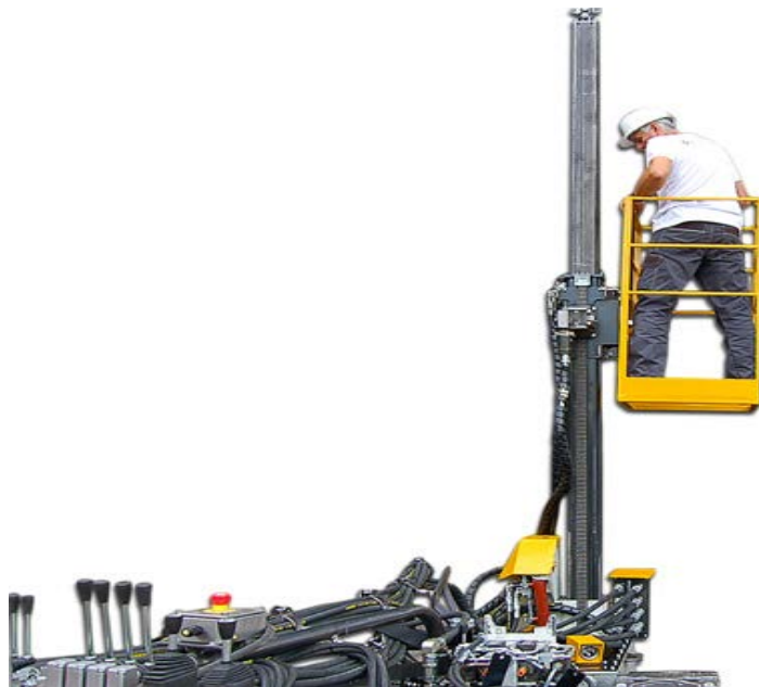
Rys. 14. Samobieżna kotwiarka ANDRIBOT – pomost roboczy (Geofinal)
