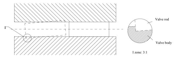
Fig. 9. Valve body and rod actual position
